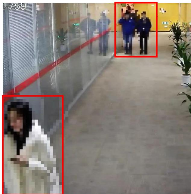
Рис. 6. Результат работы технологии наложения мозаичной маски с переменной блочностью
